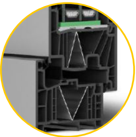
TS Plus 2.0 Flügelprofil Höhe 64 mm, Tiefe 82 mm Rahmenprofil Höhe 76 mm, Tiefe 80 mm mit LowE Folie - Passivhaus geeignet U_w - Wert = 0,70 W/m 2 K
